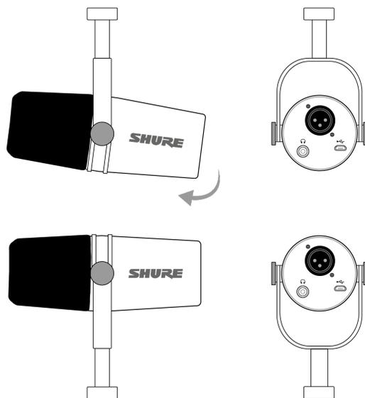
*Per capovolgere facilmente l'orientamento del microfono, allentate le viti e ruotatelo di 180 gradi.*
